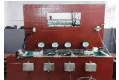
पू.सी.रे. में एलएचबी ब्रेक घटक प्रणाली के लिए परीक्षण बैंच
