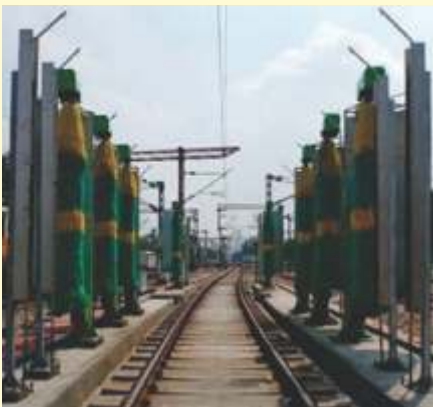
डीएलटी कॉम्प्लैक्स, नई दिल्ली में ऑटोमैटिक कोच वाशिंग प्लांट
