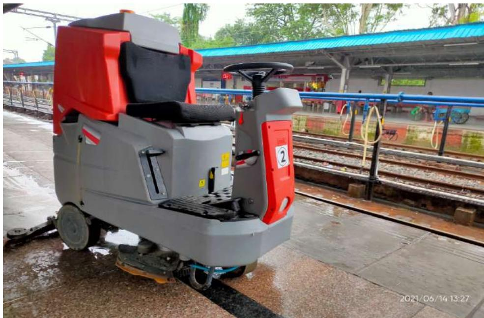
यह मशीन सेमी मैकेनाइज्ड क्लीनिंग कॉन्ट्रैक्ट के अंतर्गत कार्यरत है जो कि बैटरी आपरेटेड है इसमें उपयोग की जाने वाली चार बैटरी लीथियम आयन पर आधारित रिचार्ज मैकेनिज्म पर कार्य करती है इसमें 100 लीटर क्षमता का फ्रेश वाटर टैंक व् 100 लीटर क्षमता का डर्टी वाटर टैंक बना हुआ है। यह मशीन प्लेटफार्म की उत्कृष्ट सफाई के लिए सर्वथा उपयुक्त है।
