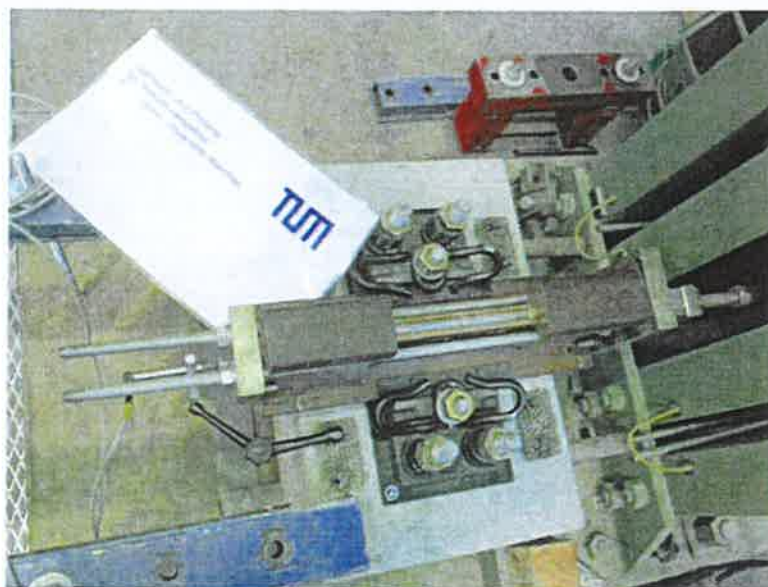
Abbildung 2: Versuchsaufbau für die Ermittlung des Durchschubwiderstands
