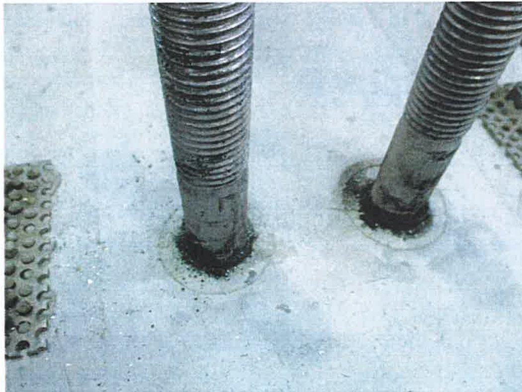
Abbildung A. 6: Ankerschrauben mit Abriebstaub (Außenseite) nach DV Figure A. 6: Anchor bolts with abrasion dust (field side) after repeated load test
