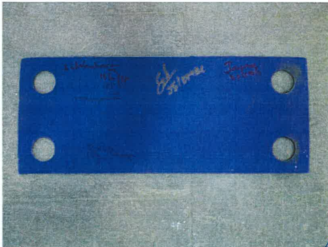
Abbildung A. 4: Zwischenplatte Zw 432/200/5 (Unterseite) nach DV Figure A. 4: Elastic pad Zw 432/200/5 (bottom side) after repeated loading
