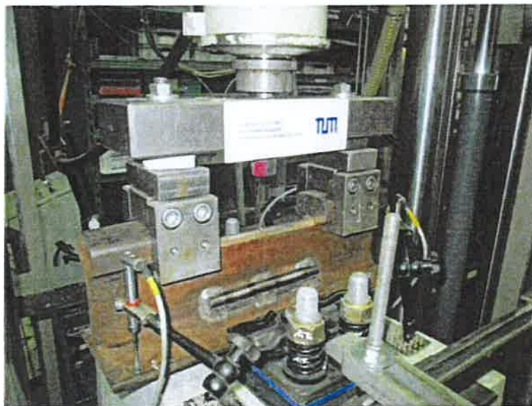
Abbildung 1: Versuchsaufbau für die Ermittlung der Spannkraft
