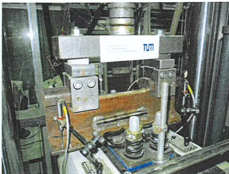
Abbildung 3: Versuchsaufbau für die Ermittlung der Systemsteifigkeit
